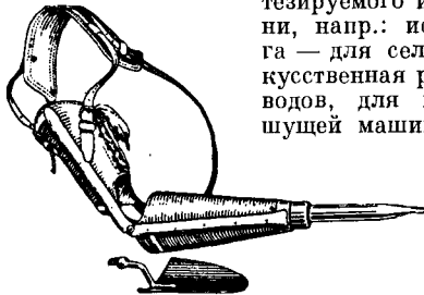
Рис. 3. Рабочий протез при ампутации верхней конечности.
